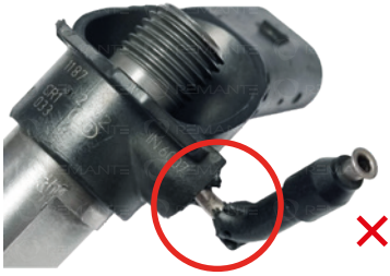
Vaurioitunut tai löysä ylivuoto
