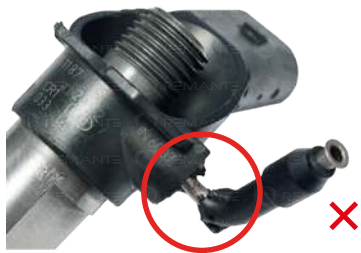
Vaurioitunut tai löysä ylivuoto
